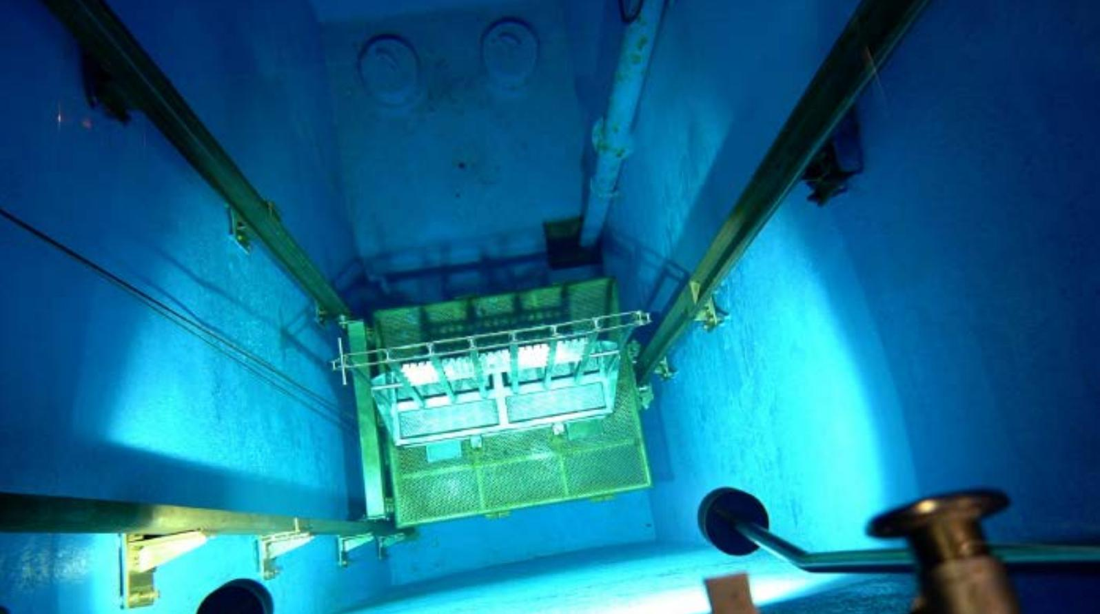
Fig. 1 Nell'immagine è visibile la piscina dell'Impianto Calliope e, sul fondo, la rastrelliera portasorgenti con le 25 barre di Cobalto-60. La luce azzurra è prodotta dalla ionizzazione dell'acqua vicino alle sorgenti (effetto Cherenkov)
