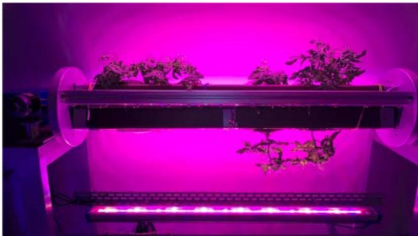
Clinostato per studiare la risposta delle piante in condizioni di microgravità simulata
