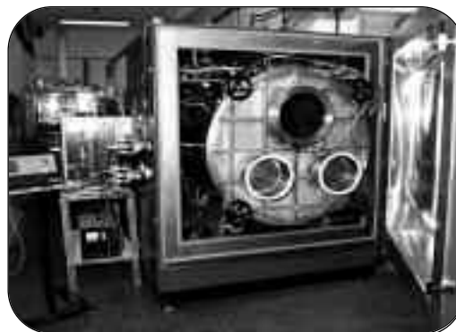
Figure 9 e 10 Nella foto a sinistra è mostrato un particolare di uno dei sistemi campione - il sistema di conteggio in coincidenza 4\pi\beta\text{-}\gamma - realizzati presso l'Istituto Nazionale di Metrologia delle Radiazioni Ionizzanti dell'ENEA per la misura assoluta dell'attività dei radionuclidi. La foto a destra mostra il sistema campione camera radon (da circa 1000 litri) per la taratura dei sistemi di misura del radon
