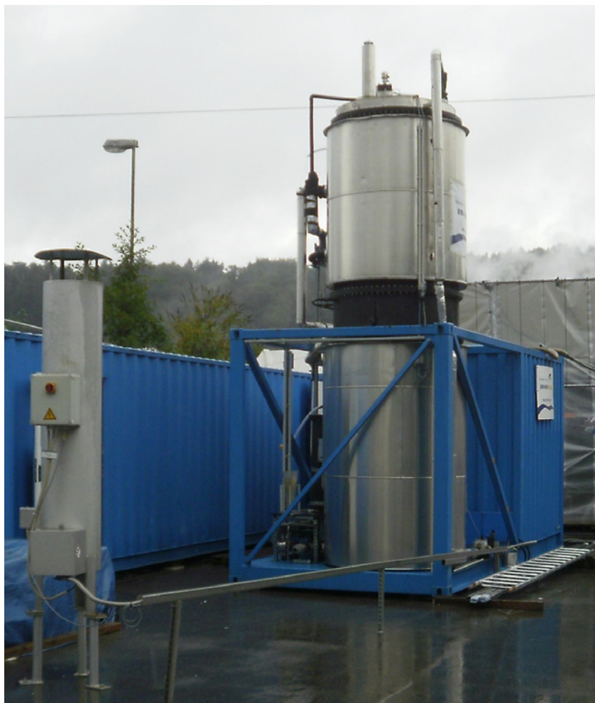
Fig. 4 Impianto di tipo UASB per il trattamento anaerobico con recupero di metano dai reflui di una cartiera tedesca, realizzato da Envirochemie nell'ambito del progetto europeo (7 th FP) Aquafit4use di cui ENEA è stata partner
