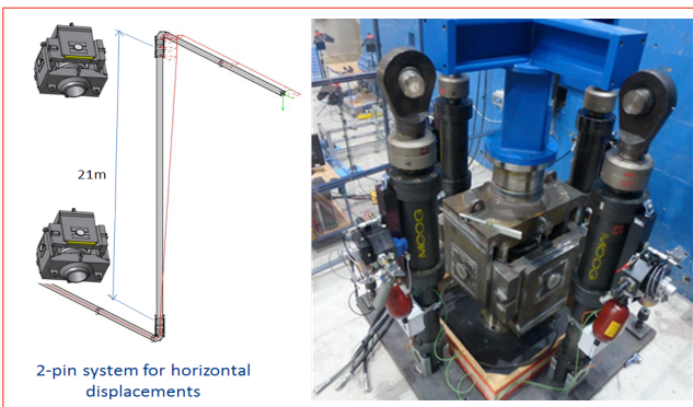
FIGURA 14 Giunti di espansione sviluppati nell'ambito del progetto SILER dal partner BOA e testati presso il laboratorio ELSA del JRC di Ispra. La corretta disposizione di 2 giunti permette di assorbire, nella tubazione che porta il vapore dal reattore ELSY alla turbina, spostamenti relativi orizzontali fino a 90 cm Per gentile concessione di BOA e JRC Ispra
