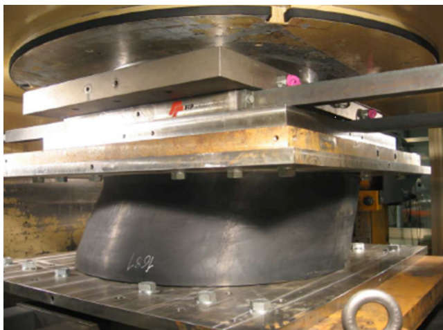
FIGURA 12 Isolatore in gomma ad alto smorzamento armato con piastre d'acciaio (Ø 1,3 m) realizzato dal partner FIP nell'ambito del Progetto SILER per l'isolamento sismico del reattore ELSY Per gentile concessione di FIP-Industriale
