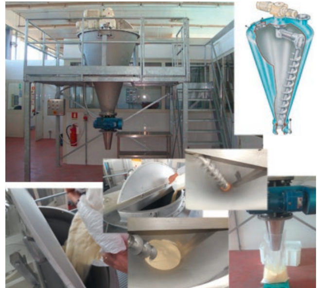
Figura 2 Impianto RM agroalimentari Centro Ricerche Trisaia dell'ENEA: omogeneizzazione di prodotti liquidi e in polvere VRIECO-NAUTA® Conical Mixer (240 L)
