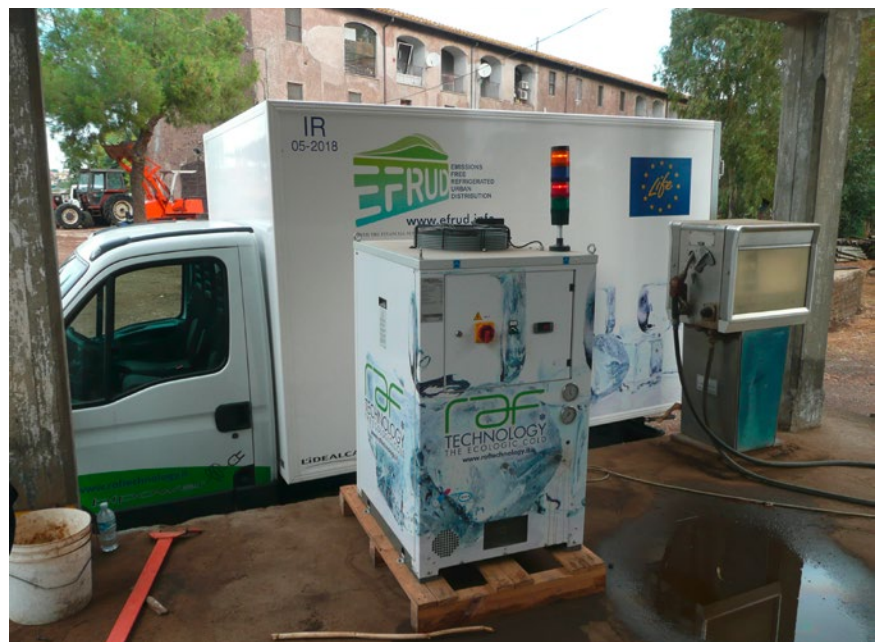
FIGURA 9 La stazione di ricarica di energia per la cella frigorifero e combustibile per il veicolo
