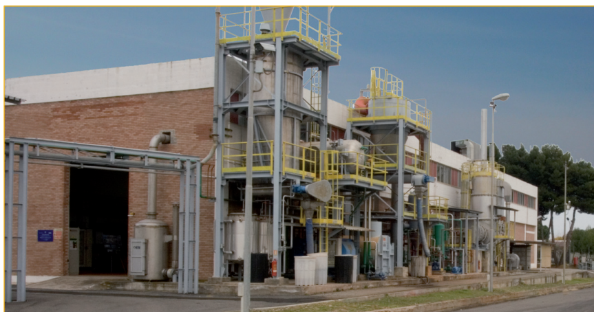
FIGURA 3 Impianto pilota di Steam Explosion (presso il Centro Ricerche ENEA Trisaia) per il trattamento della biomassa al fine di migliorare il recupero delle frazioni di cellulosa, emicellulosa e lignina e poter procedere alla loro valorizzazione per la produzione di biocarburanti, materiali plastici e chemicals
