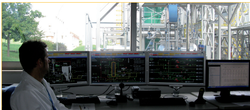
FIGURA 2 L'impianto Zecomix presso il Centro ENEA Casaccia consente di effettuare test sulle diverse fasi di una nuova tecnologia per la produzione di gas ricco di idrogeno ed energia elettrica da carbone con contemporanea cattura della CO 2
