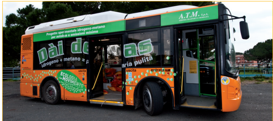
FIGURA 1 Mhybus, prototipo di autobus con motore a combustione alimentato da una miscela di idrogeno e metano. Applicazione dimostrativa per il trasporto urbano a Ravenna condotta da ENEA, Regione Emilia Romagna, Start Romagna, SOL e ASTER
