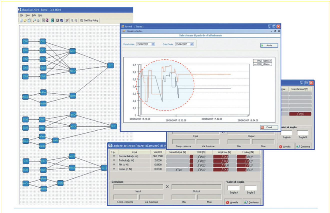
FIGURA 5 Alcune videate del software XBASE del sistema esperto [25,26] dove viene visualizzata la struttura inferenziale reticolare dei modelli di conoscenza e il contributo di certezza (barre in colore scuro) fornito dalle informazioni rilevate dai sensori
