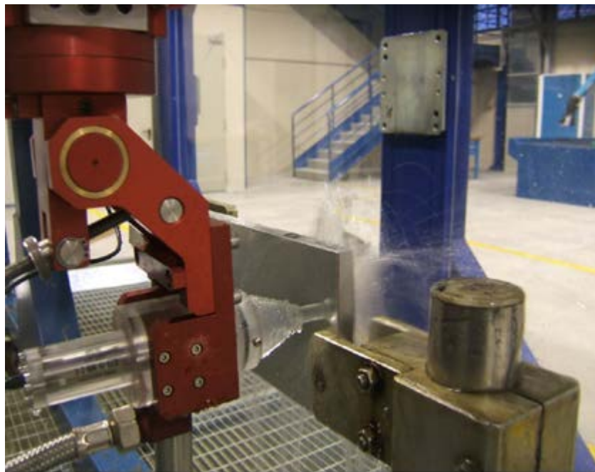
Fig.6 Sonda UT inserita nello Squirter e la colonna di acqua che si genera
