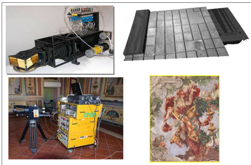
Fig. 1 In alto a sn il prototipo di IVVS realizzato per il monitoraggio dell'erosione delle piastrelle all'interno di FTU; a dx il modello 3D raccolto. In basso a sinistra il sistema RGB-ITR, a destra un particolare della volta di Pietro da Cortona scansionata ad alta risoluzione a 18 m da terra.
