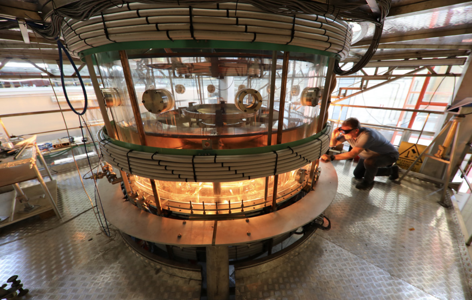
La camera della macchina Proto-Sphera all'interno della quale avviene la scarica di plasma
