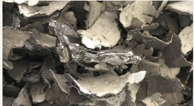
Frammenti triturati di pannello fotovoltaico
