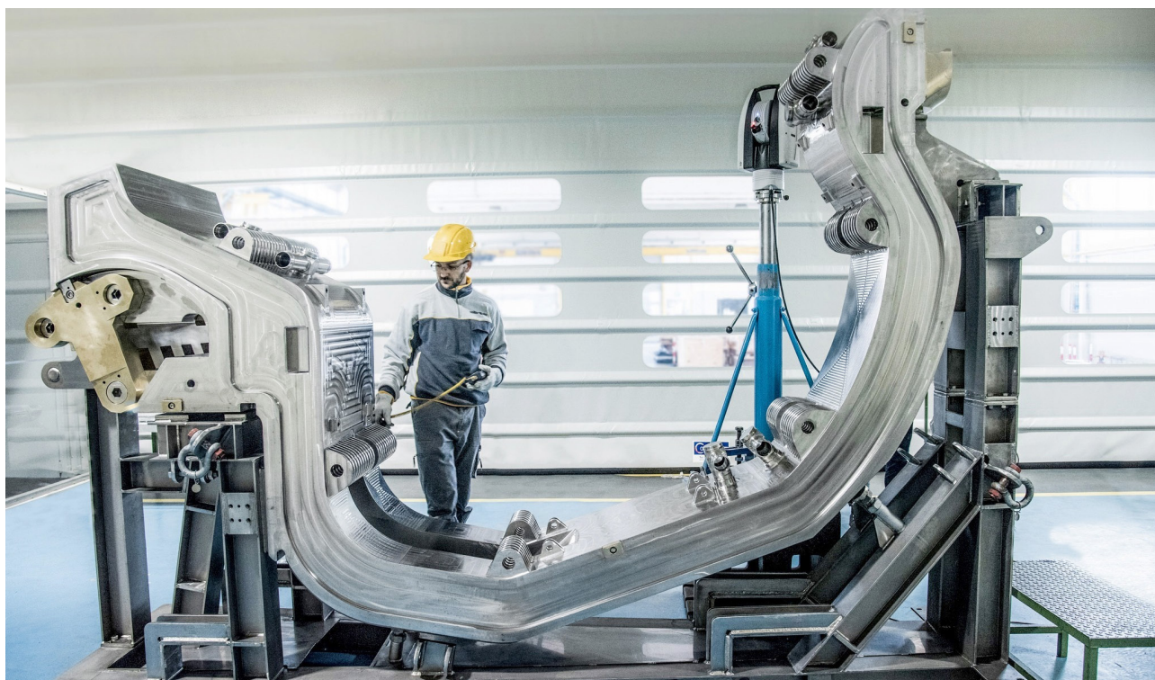
Modulo della struttura di supporto del divertore di ITER (Walter Tosto)
