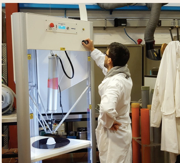
Stampante 3D per la realizzazione di componenti ceramici da additive manufacturing con la tecnica LDM (Liquid Deposition Modelling)
