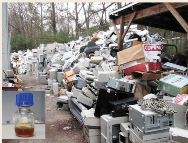
Rifiuti delle plastiche di apparecchiature elettriche ed elettroniche (RAEE); nella foto piccola, olio di pirolisi ricavabile dalla plastica, utilizzabile come combustibile o materia prima seconda
