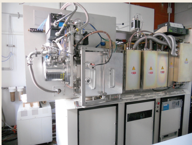
Impianto di sputtering utilizzato per la sperimentazione di film stabili di TCO
