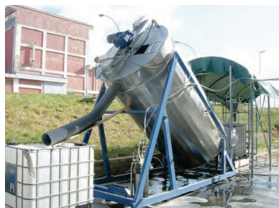
Digestore anaerobico mobile
