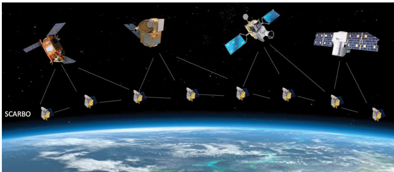
Fig. 2 La piattaforma basata su OneWeb utilizzata come base per il concetto di costellazione SCARBO insieme alle missioni oggi operative
