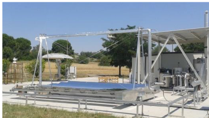
Esempio di collettore Linear-Fresnel in fase di test presso il Laboratorio
