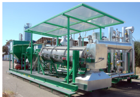
◀ Impianto di gassificazione a letto fisso Updraft da 150 kW
