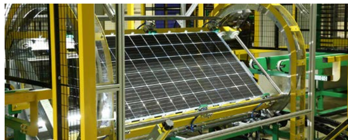
Pannelli fotovoltaici ad eterogiunzione fabbricati nello stabilimento 3SUN-Enel Green Power di Catania
