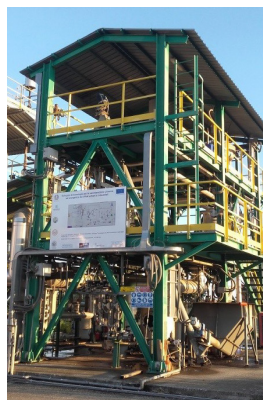
Impianto pilota di gassificazione multistadio da 500 kW
