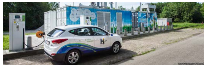
Un veicolo elettrico alimentato da celle a combustibile si rifornisce di idrogeno (fonte: Hydrogenics & Waterstofnet)
