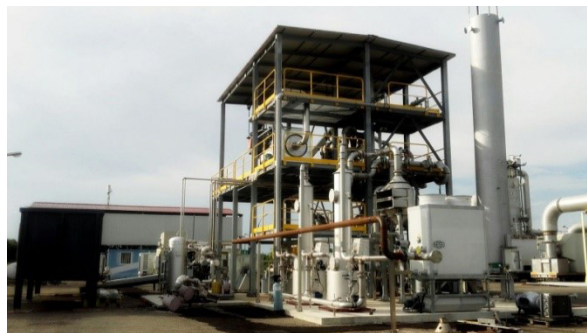
Impianto pilota di gassificazione multistadio da 500 kW
