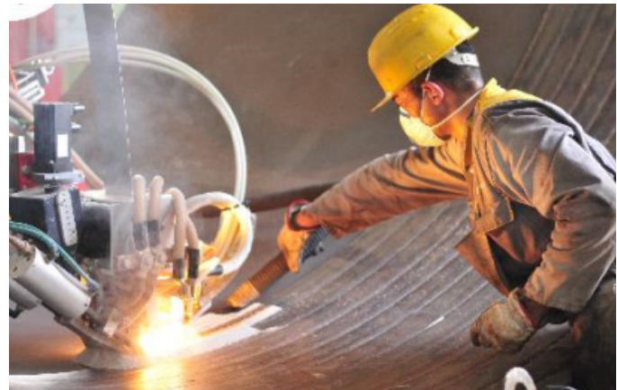
Fabbricazione del rivestimento resistente al piombo liquido
