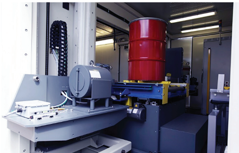
Fig. 2 Tomografo Gamma a Scansione, uno dei sistemi di caratterizzazione radiologica utilizzati in Nucleco
