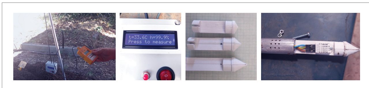
Fig. 3 Test di un sensore (DHT22 per umidità e temperatura, meno di 3 euro) e studio della forma ottimale delle punte
