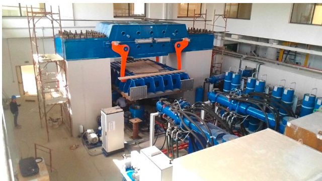
FIGURA 2 Il banco di prova per dispositivi antisismici (ASD Test Facility) di EUROLAB
