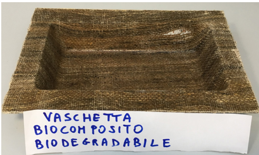
Stampo prova di vaschetta in fibra di canapa e PHA ottenuto da siero di latte (progetto Biocosi)
