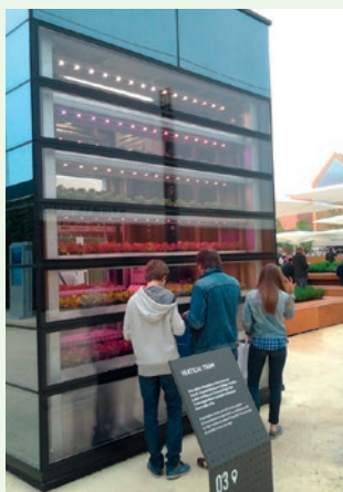
Particolare della Vertical Farm, serra multistrato chiusa e automatizzata esposta a EXPO 2015
