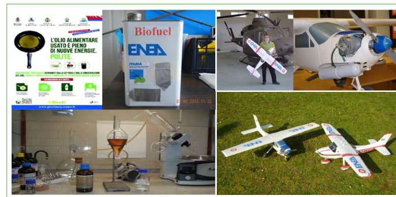
Figura 4 Messa a punto e test di motorizzazioni aeronautiche innovative di UAV per lo sfruttamento di combustibile aeronautico ottenuto da biodiesel derivato dal riciclo di olii alimentari esausti
