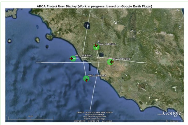
Figura 6 Simulazione di quattro UAV in rotte di collisione controllate e risolte dall'algoritmo del sistema
