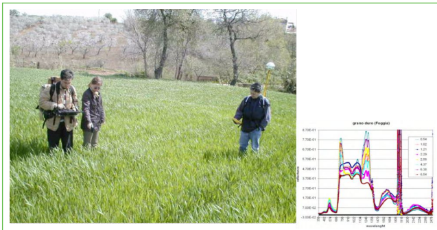
Figura 2 Rilevazione di misure spettrali di calibrazione relative a piantagioni di grano duro su suoli a diverso grado di salinizzazione tramite radiometro iperspettrale portatile ASD-FieldspecPro col supporto di ricevitore GPS per la georeferenziazione
