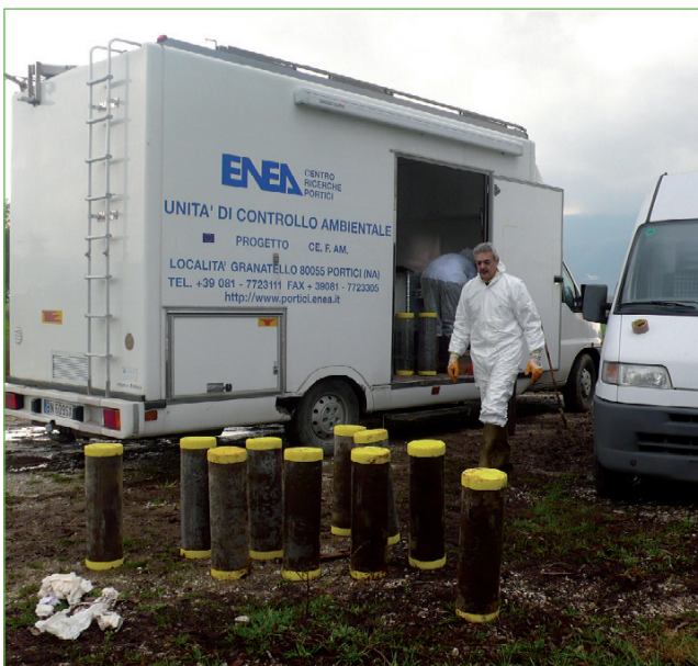
Figura 1 Prelievo in campo di carote indisturbate di suolo (ASTM Standard Guide)
