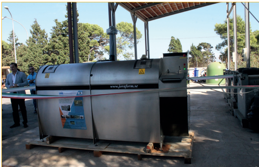
FIGURA 1 Il compostatore per piccole comunità installato a Favignana
