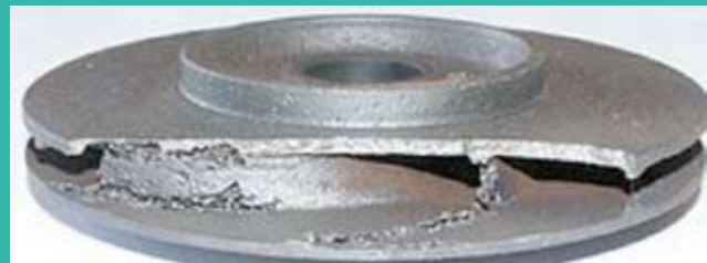
FIGURA 3 Girante di una pompa danneggiata dalla cavitazione
