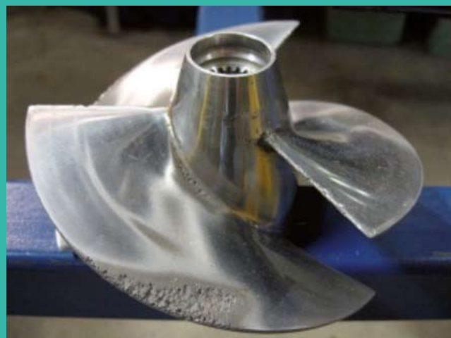
FIGURA 4 Elica con danni provocati dalla cavitazione, in particolare in vicinanza del bordo, dove la velocità della lama è massima
