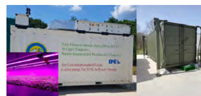
Fig. 5 Container CHEF in pannello a sx con in basso dettaglio dell'interno dello spazio di coltivazione per la coltura di microverdure. Nel pannello a dx la factory farm MIG (Military Innovative Greenhouse)
