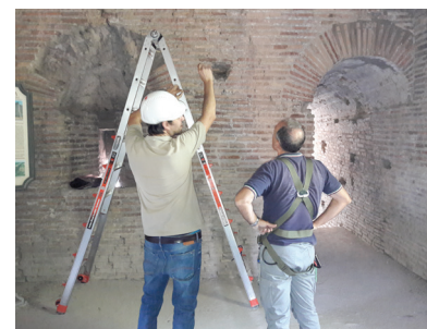
Installazione di sensori sulle antiche Mura Aureliane di Roma per monitorare gli effetti di smog e traffico
