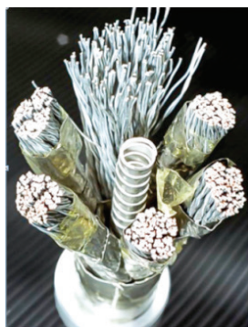
Fig. 1a Cavo in Nb 3 Sn in scala 1:1 per i magneti di ITER (prestazioni: 68 kA@4.2 K, 12 T)
