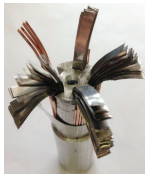
Fig. 1b Cavo realizzato da ENEA e TRATOS Cavi SpA, costituito da 150 nastri a base di YBCO su matrice di alluminio (prestazioni: 20 kA@77K, self-field)
