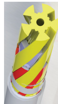
Fig. 1b Cavo realizzato da ENEA e TRATOS Cavi SpA, costituito da 150 nastri a base di YBCO su matrice di alluminio (prestazioni: 20 kA@77K, self-field)
