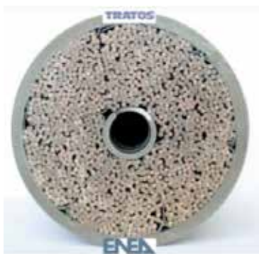
Fig. 1a Cavo in Nb3Sn in scala 1:1 per i magneti di ITER (prestazioni: 68 kA@4.2 K, 12 T)
