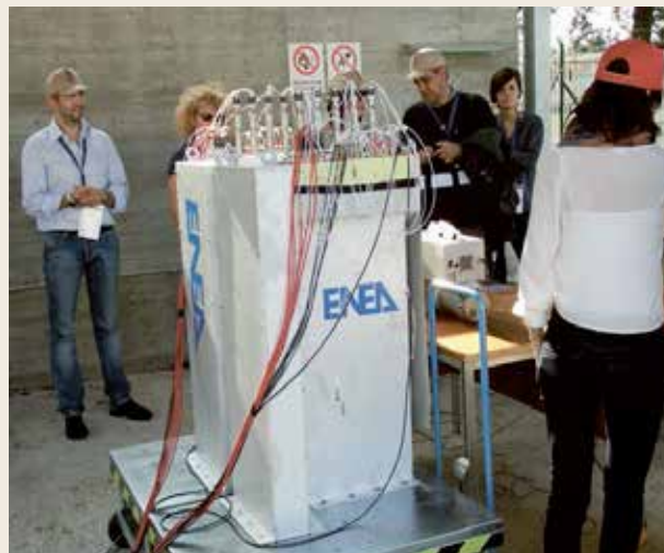
Sistema NAI (Neutron Active Interrogation system) per la rivelazione in situ e in tempo reale di materiale nucleare in campioni sospetti
