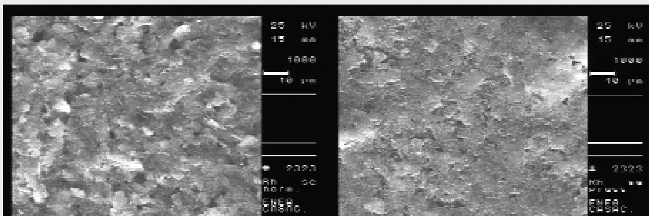
Figura 18. Fotografie SEM di superfici di elettrodi di grafite pressati (destra) e non (sinistra)
