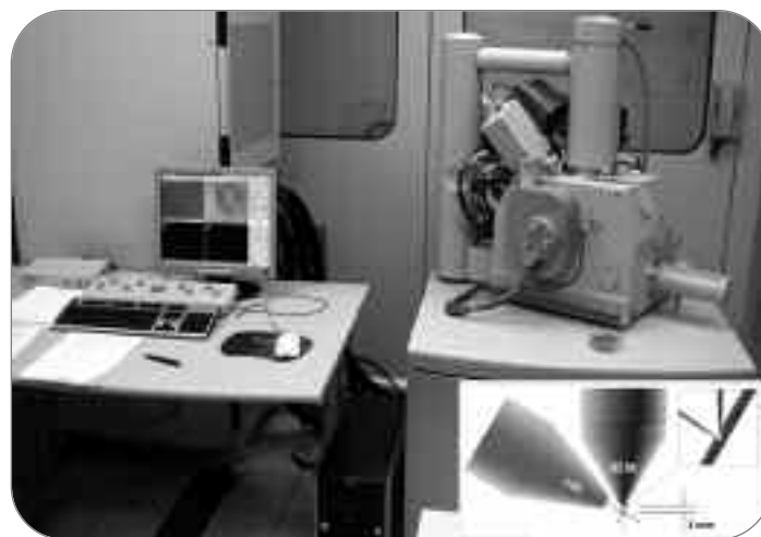
Figura 1 Il FIB a doppio fascio installato nelle camere pulite del Centro ENEA di Portici. Nell'inserto è schematizzata la posizione eucentrica che permette di ispezionare tramite il SEM le lavorazioni eseguite con il FIB
