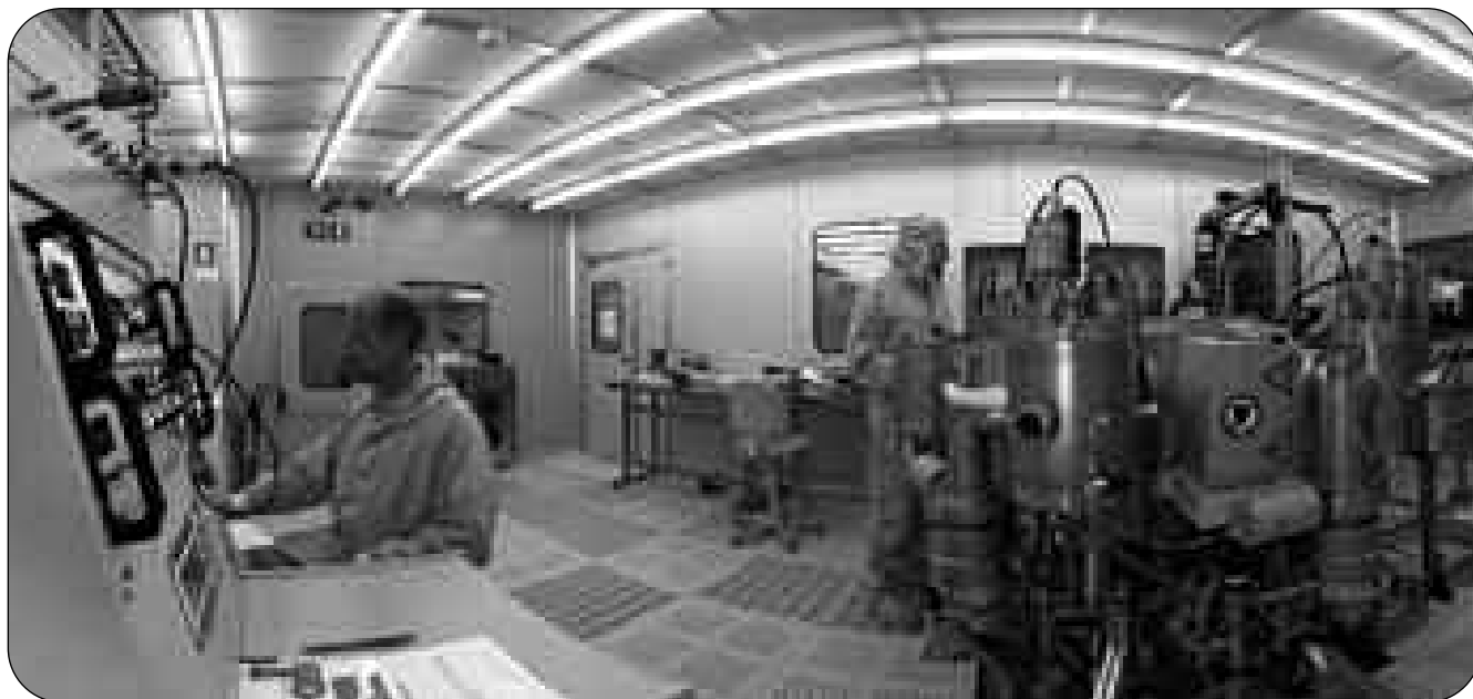
La camera pulita per applicazioni microelettroniche del Centro di Portici: qui vengono realizzati OLED, loghi e matrici attive
