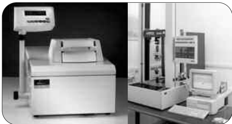
Figura 6 Calorimetro differenziale e dinamometro utilizzati per la caratterizzazione del pannello sandwich riflettente
