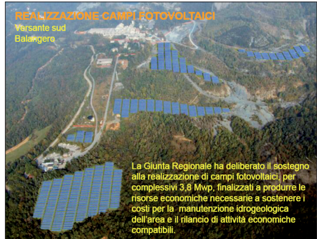
FIGURA 6 Recupero del SIN, "ex-amiantifero" di Balangero e Corio per mezzo del riutilizzo delle superfici disponibili per la realizzazione di "campi fotovoltaici" Fonte: G. Armiento, S. Cappucci, F. De Lia, M. Dotti, L. Falconi, R. Levizzari, M. Maffucci. (2009) [3]
