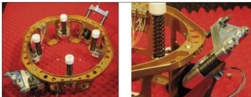
FIGURA 3 Il modello di volo dell'adattatore e sistema di separazione di ALMASat-1
