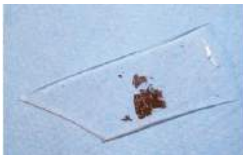
La tecnica di esfoliazione messa a punto a Portici permette di realizzare campioni puri con dimensioni di un ordine di grandezza maggiori rispetto a quelle riportate in letteratura.
