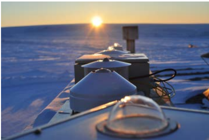
Fig.4 Radiometri operativi presso il Thule High Arctic Atmospheric Observatory; questi strumenti servono a misurare i flussi di radiazione in varie bande spettrali e a studiare i processi che regolano il clima artico. La foto è stata presa alcuni giorni dopo il termine della notte artica, che a Thule avviene con il primo sorgere del sole attorno al 20 febbraio.
