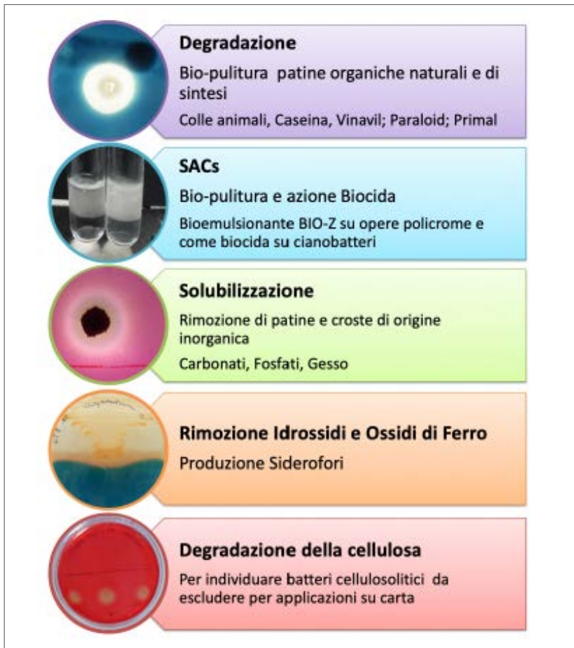
Fig.3 Test di laboratorio per saggiare le funzioni metaboliche dei batteri utili per la bio-pulitura delle opere d'arte e per evitare effetti indesiderati sul materiale dell'opera.
