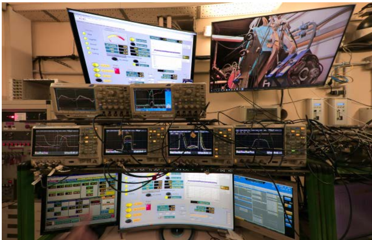
Vista di una delle postazioni di controllo dell'acceleratore lineare TOP IMPLART. Il sistema di gestione e controllo è interamente realizzato in ENEA come il linac stesso
