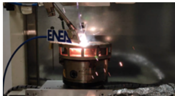
Fig. 2 - Test di Saldatura laser "key hole" di superlega di nichel IN 718 per la messa a punto di processi di saldatura per motori aerospaziali
