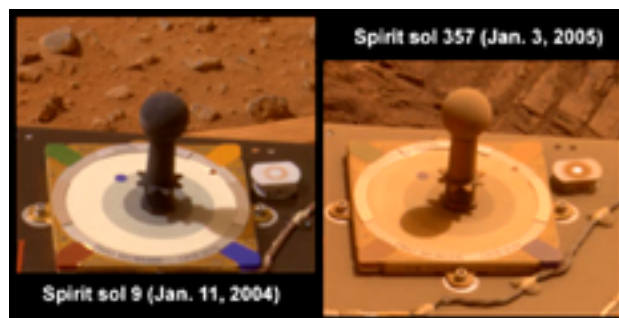
Fig. 4: La meridiana/bussola solare del rover Spirit su Marte. La foto di destra mostra chiaramente l'effetto delle polveri marziane dopo un solo anno Source: Image Courtesy Nasa/JPL
