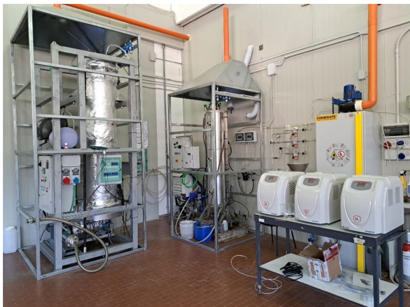
Figura 1 - Impianti pilota per l'upgrading biologico del biogas mediante processo di metanazione idrogenotrofa, in configurazione ex situ. Impianti pilota da 60 L (a destra) e 200 L (a sinistra).
