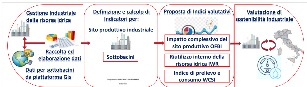
Figura 1: Sintesi grafica del metodo proposto per la valutazione degli impatti ambientali dell'uso della risorsa idrica nei processi produttivi.
