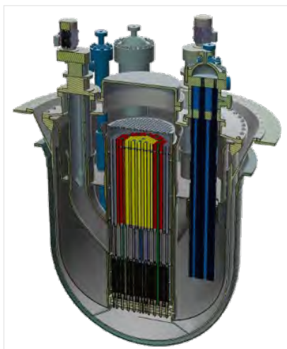
Dimostratore Europeo del Reattore Veloce Avanzato al Piombo (ALFRED): rappresentazione del sistema primario del reattore, la parte in cui avviene la produzione del calore utilizzato per generare energia elettrica
