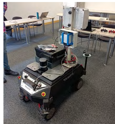
Figura 1: Sensori di raggi gamma e neutroni assemblati (a sinistra, in alto) e montati insieme ad altri su un robot di prova nel progetto CLEANDEM (a destra)
