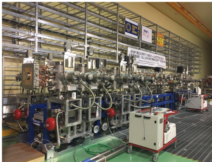
Figura 3: Il primo stadio dell'impianto IFMIF-EVEDA, realizzato dall'INFN e installato a Rokkasho (Giappone)
